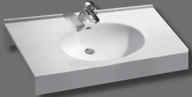
Einzelwaschtisch in einem Stück nach Maß gegossen, Mehrfachwaschtisch aus mehreren Einzelwaschtischen fugenlos miteinander verklebt und fertig konfektioniert, mit seitlichen Ablageflächen, bauseits bearbeitbar, Beckenform oval, alternativ mit/ohne Überlauf, mit Lochbohrung für Einlochbatterie, mit angeformter Wischleiste mit Hohlkehle, mit angeformter Frontblende, mit Rückwand für Stockschraubenbefestigung.
