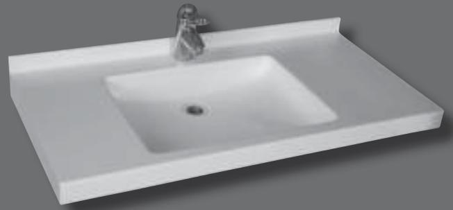
Einzelwaschtisch in einem Stück nach Maß gegossen, Mehrfachwaschtisch aus mehreren Einzelwaschtischen fugenlos miteinander verklebt und fertig konfektioniert, mit seitlichen Ablageflächen, bauseits bearbeitbar, Beckenform eckig, ohne Überlauf, mit Lochbohrung für Einlochbatterie, mit angeformter Wischleiste mit Hohlkehle, mit angeformter Frontblende, mit Rückwand für Stockschraubenbefestigung.
