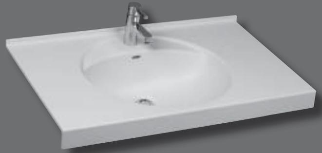
Einzelwaschtisch in einem Stück nach Maß gegossen, Mehrfachwaschtisch aus mehreren Einzelwaschtischen fugenlos miteinander verklebt und fertig konfektioniert, mit seitlichen Ablageflächen, bauseits bearbeitbar, Beckenform rund, alternativ mit/ohne Überlauf, mit integrierter Armaturenbank, mit Lochbohrung für Einlochbatterie, mit angeformter Wischleiste mit Hohlkehle, mit angeformter Frontblende.
