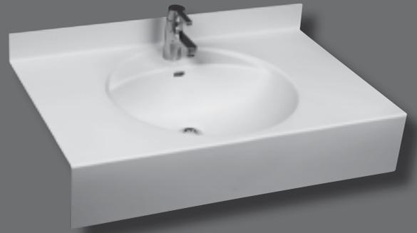
Einzelwaschtisch in einem Stück nach Maß gegossen, Mehrfachwaschtisch aus mehreren Einzelwaschtischen fugenlos miteinander verklebt und fertig konfektioniert, mit seitlichen Ablageflächen, bauseits bearbeitbar, Beckenform rund, alternativ mit/ohne Überlauf, mit integrierter Armaturenbank, mit Lochbohrung für Einlochbatterie, mit angeformter Wischleiste mit Hohlkehle, mit angeformter Frontblende.
