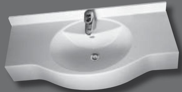
Einzelwaschtisch in einem Stück nach Maß gegossen, Mehrfachwaschtisch aus mehreren Einzelwaschtischen fugenlos miteinander verklebt und fertig konfektioniert, mit seitlichen Ablageflächen, bauseits bearbeitbar, Beckenform oval, alternativ mit/ohne Überlauf, mit integrierter Armaturenbank, mit Lochbohrung für Einlochbatterie, mit angeformter Wischleiste mit Hohlkehle, mit angeformter Frontblende.
