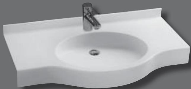
Einzelwaschtisch in einem Stück nach Maß gegossen, Mehrfachwaschtisch aus mehreren Einzelwaschtischen fugenlos miteinander verklebt und fertig konfektioniert, mit seitlichen Ablageflächen, bauseits bearbeitbar, Beckenform oval, ohne Überlauf, mit Lochbohrung für Einlochbatterie, mit angeformter Wischleiste mit Hohlkehle, mit angeformter Frontblende.
