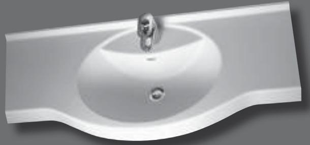
Einzelwaschtisch in einem Stück nach Maß gegossen, Mehrfachwaschtisch aus mehreren Einzelwaschtischen fugenlos miteinander verklebt und fertig konfektioniert, mit seitlichen Ablageflächen, bauseits bearbeitbar, Beckenform oval, alternativ mit/ohne Überlauf, mit integrierter Armaturenbank, mit Lochbohrung für Einlochbatterie, mit angeformter Wischleiste mit Hohlkehle, mit angeformter Frontblende.
