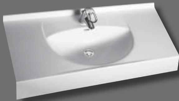
Einzelwaschtisch in einem Stück nach Maß gegossen, Mehrfachwaschtisch aus mehreren Einzelwaschtischen fugenlos miteinander verklebt und fertig konfektioniert, mit seitlichen Ablageflächen, bauseits bearbeitbar, Beckenform oval, alternativ mit/ohne Überlauf, mit integrierter Armaturenbank, mit Lochbohrung für Einlochbatterie, mit Schwallrand an Vorderkante der Ablagefläche, mit angeformter Wischleiste mit Hohlkehle, mit angeformter Frontblende.
