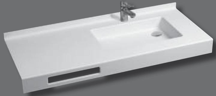
Einzelwaschtisch in einem Stück nach Maß gegossen, Mehrfachwaschtisch aus mehreren Einzelwaschtischen fugenlos miteinander verklebt und fertig konfektioniert, mit seitlichen Ablageflächen, bauseits bearbeitbar, Beckenform eckig, ohne Überlauf, mit Lochbohrung für Einlochbatterie, mit angeformter Wischleiste mit Hohlkehle, mit angeformter Frontblende.
