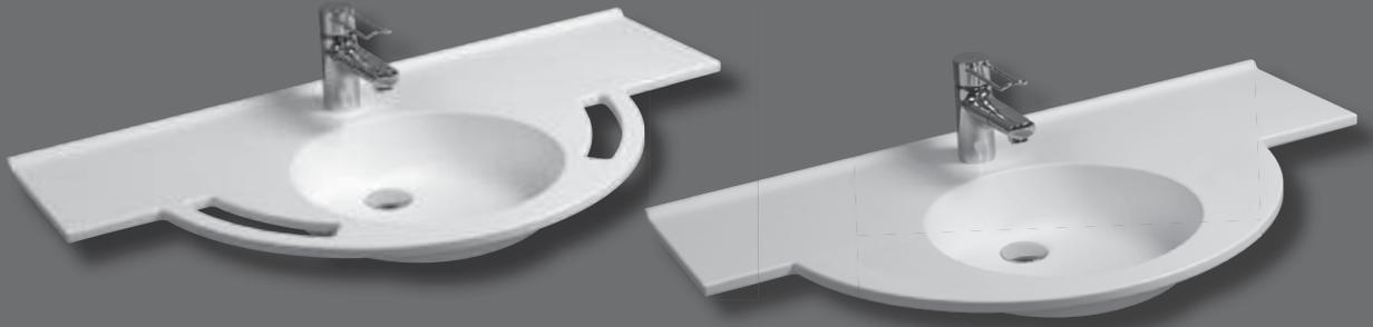
Einzelwaschtisch in einem Stück nach Maß gegossen, Mehrfachwaschtisch aus mehreren Einzelwaschtischen fugenlos miteinander verklebt und fertig konfektioniert, mit seitlichen Ablageflächen (Materialstärke: 20 mm), bauseits bearbeitbar, Beckenform rund, ohne Überlauf, mit Lochbohrung für Einlochbatterie, mit angeformter Wischleiste mit Hohlkehle, mit Rückwand für Stockschraubenbefestigung.
