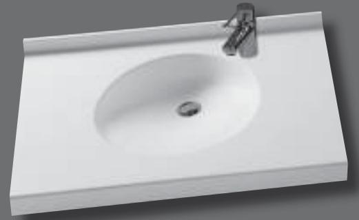
Einzelwaschtisch in einem Stück nach Maß gegossen, Mehrfachwaschtisch aus mehreren Einzelwaschtischen fugenlos miteinander verklebt und fertig konfektioniert, mit seitlichen Ablageflächen, bauseits bearbeitbar, Beckenform oval, ohne Überlauf, mit Lochbohrung für Einlochbatterie, mit angeformter Wischleiste mit Hohlkehle, mit angeformter Frontblende, mit Rückwand für Stockschraubenbefestigung.
