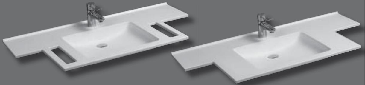
Einzelwaschtisch in einem Stück nach Maß gegossen, Mehrfachwaschtisch aus mehreren Einzelwaschtischen fugenlos miteinander verklebt und fertig konfektioniert, mit seitlichen Ablageflächen (Materialstärke: 20 mm), bauseits bearbeitbar, Beckenform eckig, ohne Überlauf, mit Lochbohrung für Einlochbatterie, mit angeformter Wischleiste mit Hohlkehle, mit Rückwand für Stockschraubenbefestigung.
