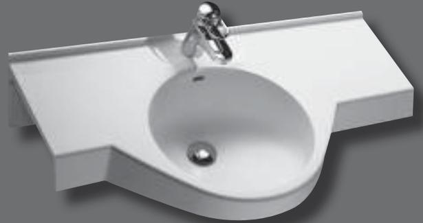
Einzelwaschtisch in einem Stück nach Maß gegossen, Mehrfachwaschtisch aus mehreren Einzelwaschtischen fugenlos miteinander verklebt und fertig konfektioniert, mit seitlichen Ablageflächen, bauseits bearbeitbar, Beckenform rund, alternativ mit/ohne Überlauf, mit Lochbohrung für Einlochbatterie, mit angeformter Wischleiste mit Hohlkehle, mit angeformter Frontblende, mit Rückwand für Stockschraubenbefestigung.
