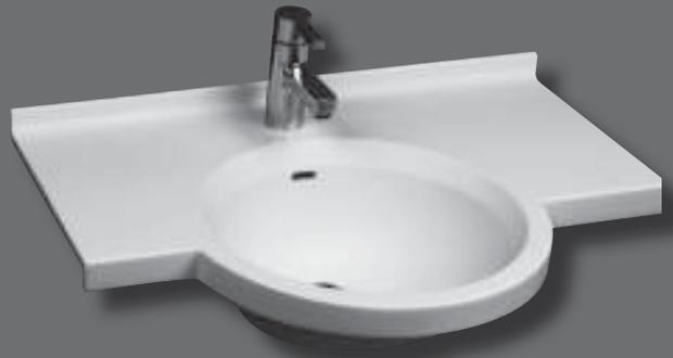
Einzelwaschtisch in einem Stück nach Maß gegossen, Mehrfachwaschtisch aus mehreren Einzelwaschtischen fugenlos miteinander verklebt und fertig konfektioniert, mit seitlichen Ablageflächen, bauseits bearbeitbar, Beckenform rund, alternativ mit/ohne Überlauf, mit Lochbohrung für Einlochbatterie, mit angeformter Wischleiste mit Hohlkehle, mit angeformter Frontblende, mit Möbelkante für Anschluss von Verkleidung/Badmöbel.
